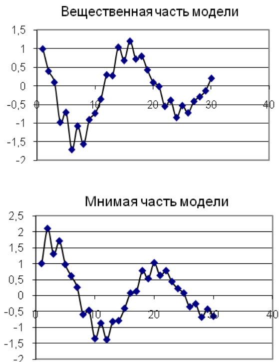
Рис. 6. Действительная и мнимая части комплекснозначной авторегрессионной модели второго порядка (9.10)
